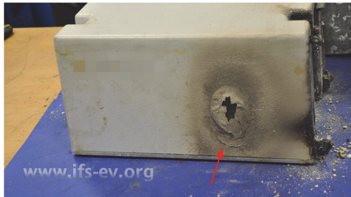
Am Gehäuse eines der drei Akkus gibt es Brandschäden, die auf die Schadenentstehung hinweisen.
