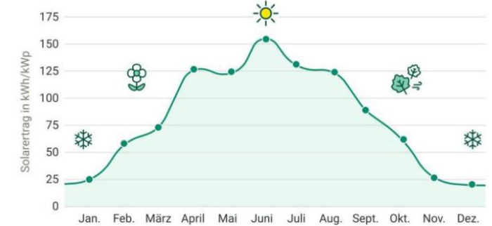
Ertrag einer PV-Anlage im Jahresverlauf
