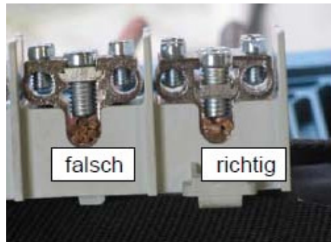
Brand nach Kurzschluss (Ursache: lose Klemmstelle durch falsch eingelegtes Gewindeplättchen)
